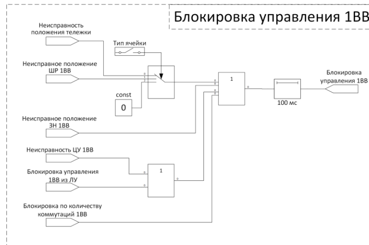
Рис. ЦУ. 5. Схема работы «Блокировка управления 1ВВ» (Аналогично осуществляется работа для остальных выключателей)
