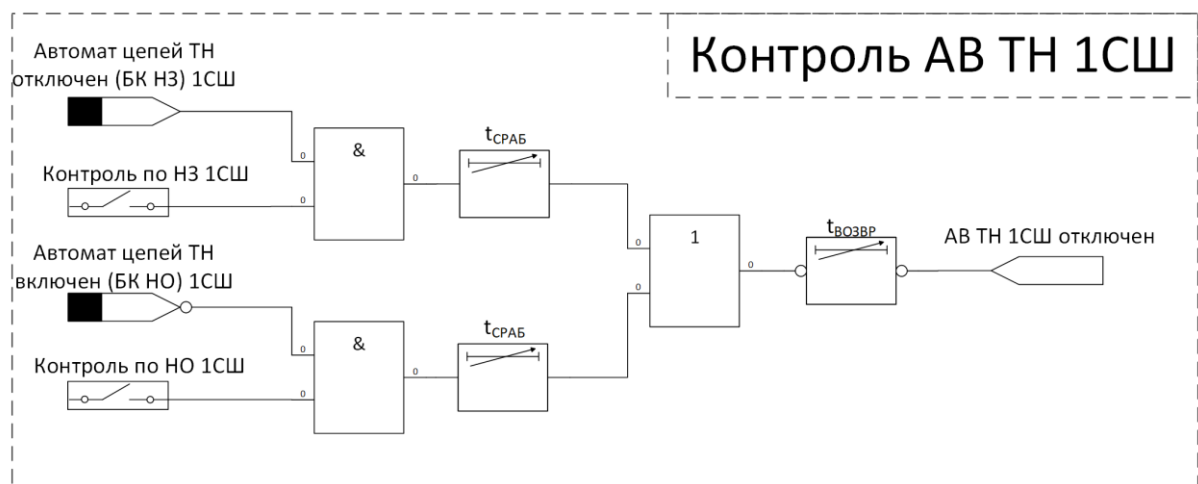
Рис. Контроль ТН. 1. Схема «Контроль АВ ТН на 1СШ». (Аналогичная логика работы для других секций шин и ТН на КЛ)
