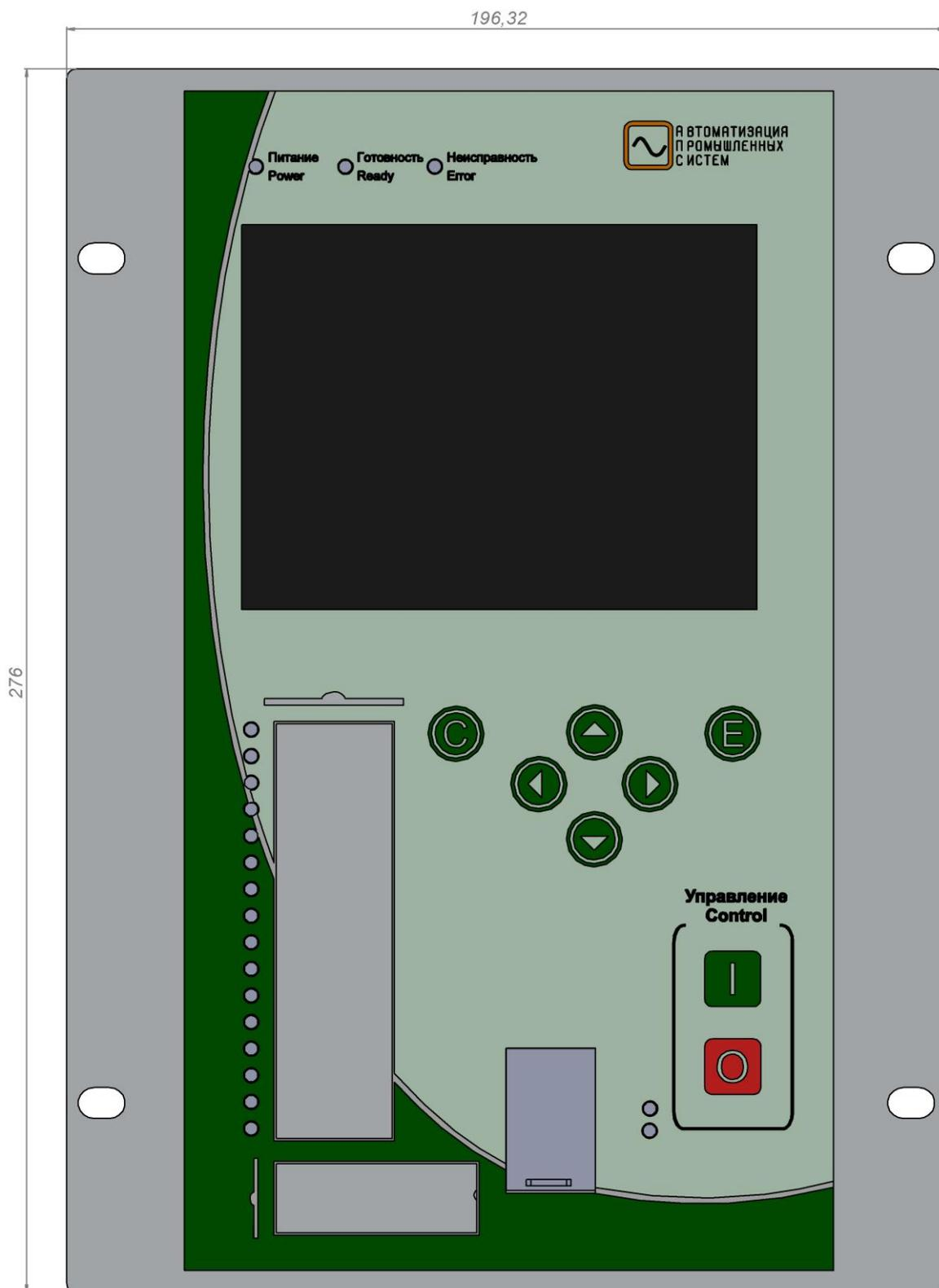
Рис. П2.3. Чертеж передней части терминала «МИР 100»
