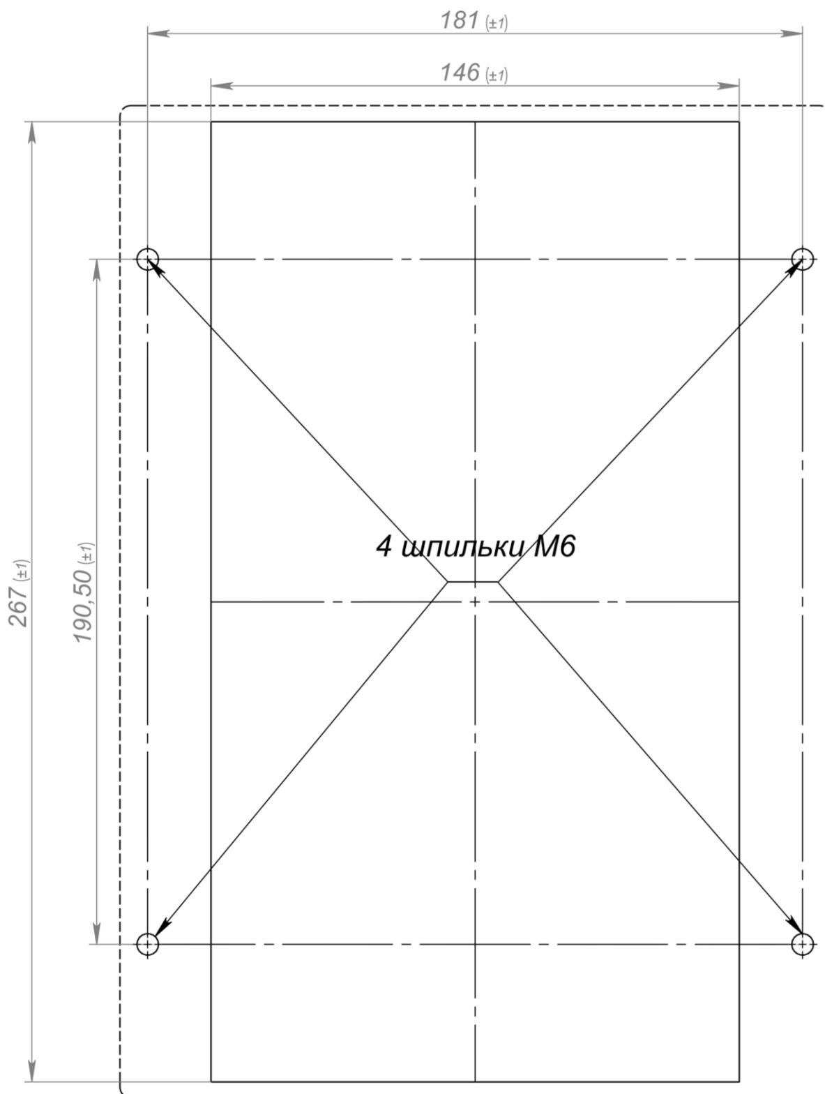
**Рис. П2.8.** Монтажные отверстия для установки терминала «МИР 100» с внутренней стороны шкафа
