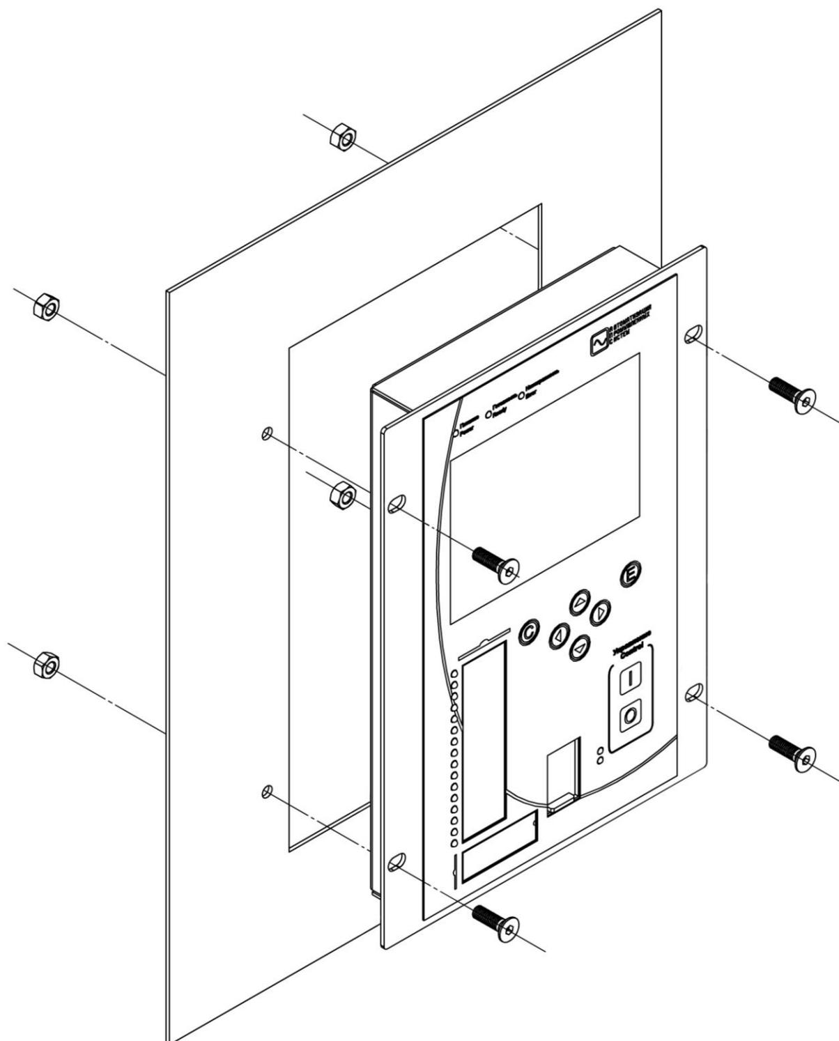
Рис. П2.13. CutOut крепления выносного дисплея с внешней стороны шкафа
