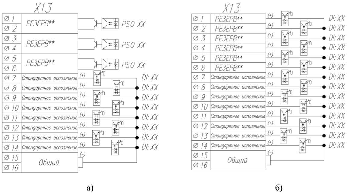
**Рис. ПЗ.1.** Дополнительные исполнения платы X13
