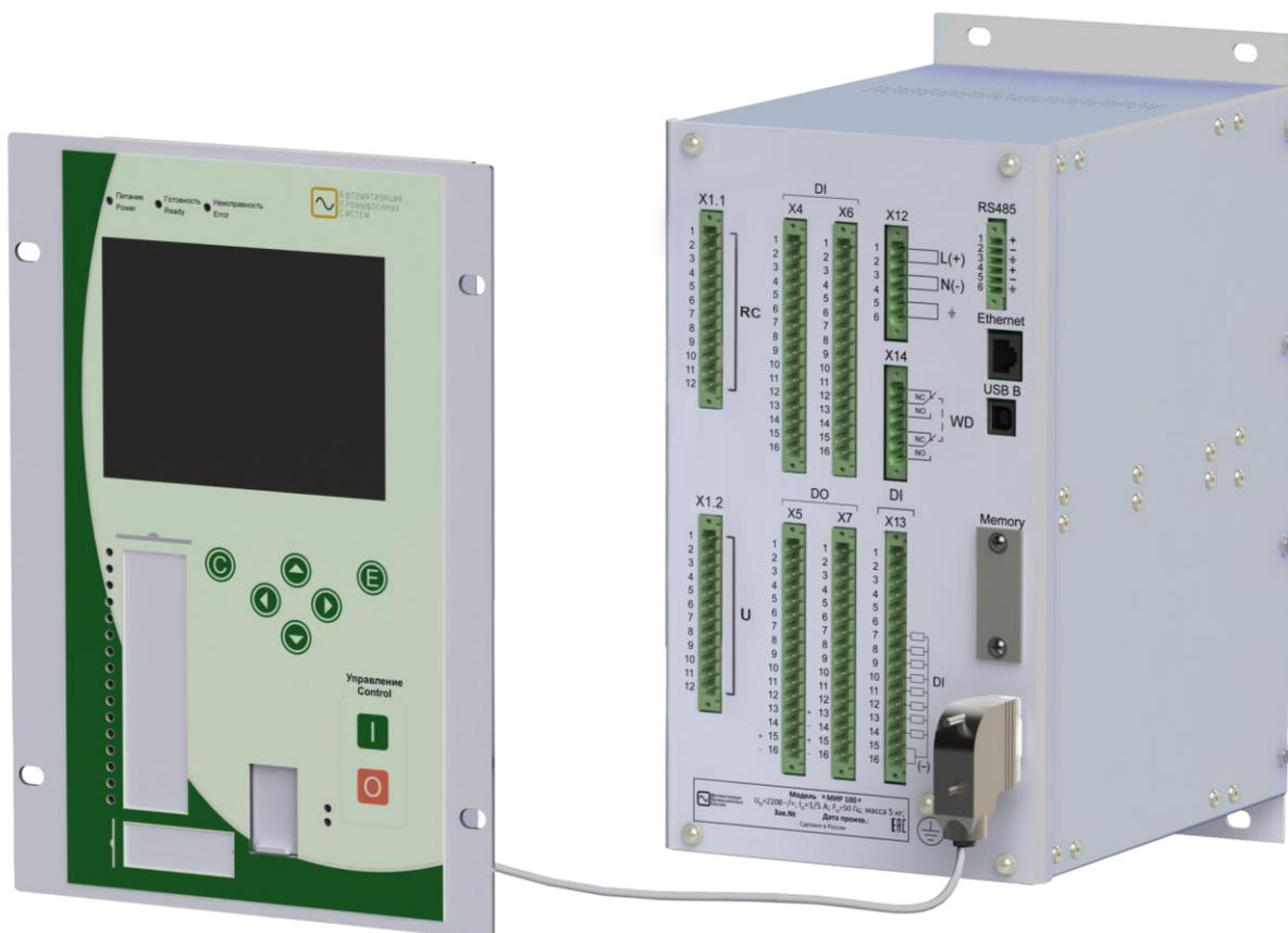
Рис. П2.2. Исполнение терминала «МИР 100» с выносным дисплеем
