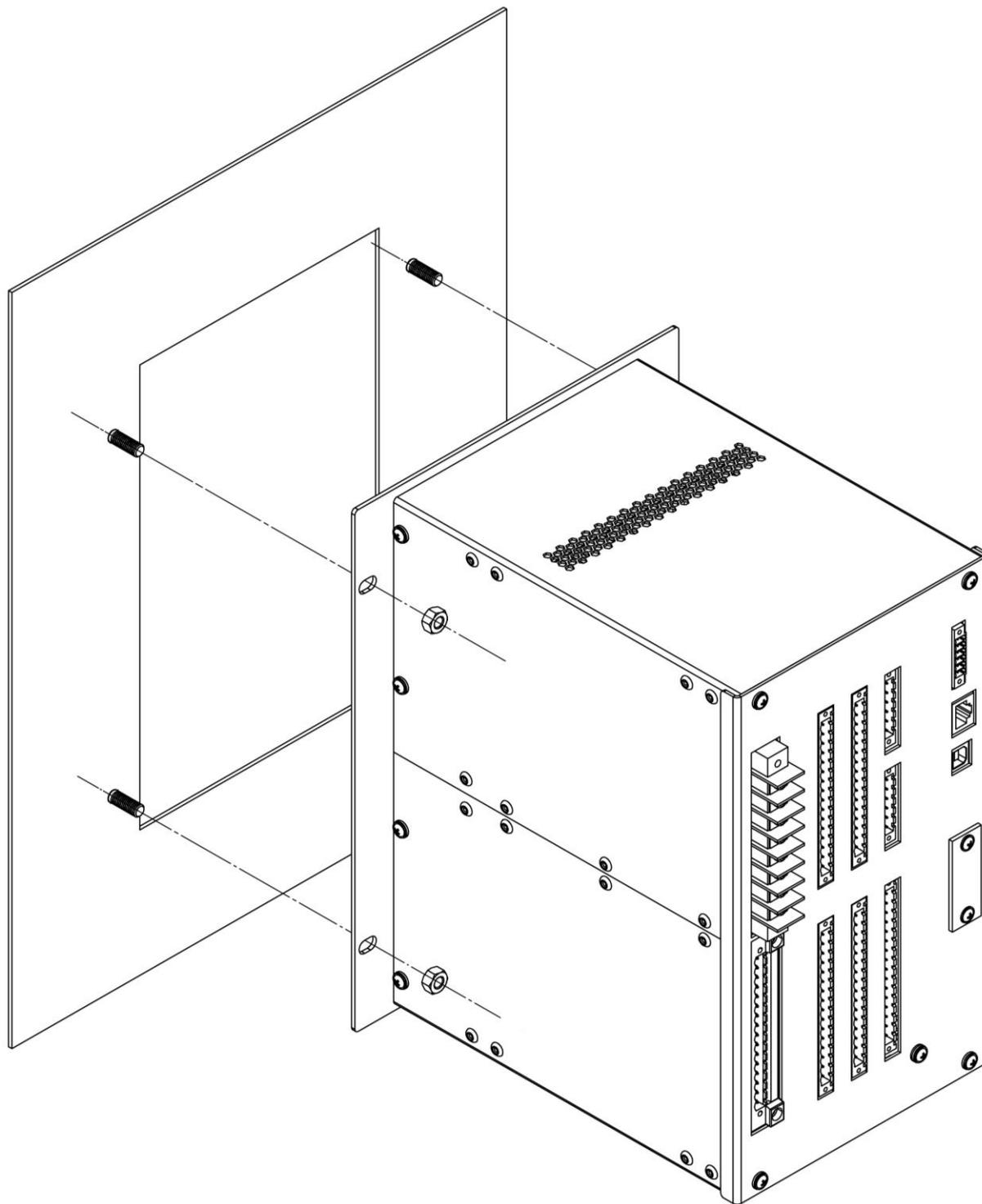
Рис. П2.7. CutOut крепления терминала «МИР 100» с внутренней стороны шкафа
