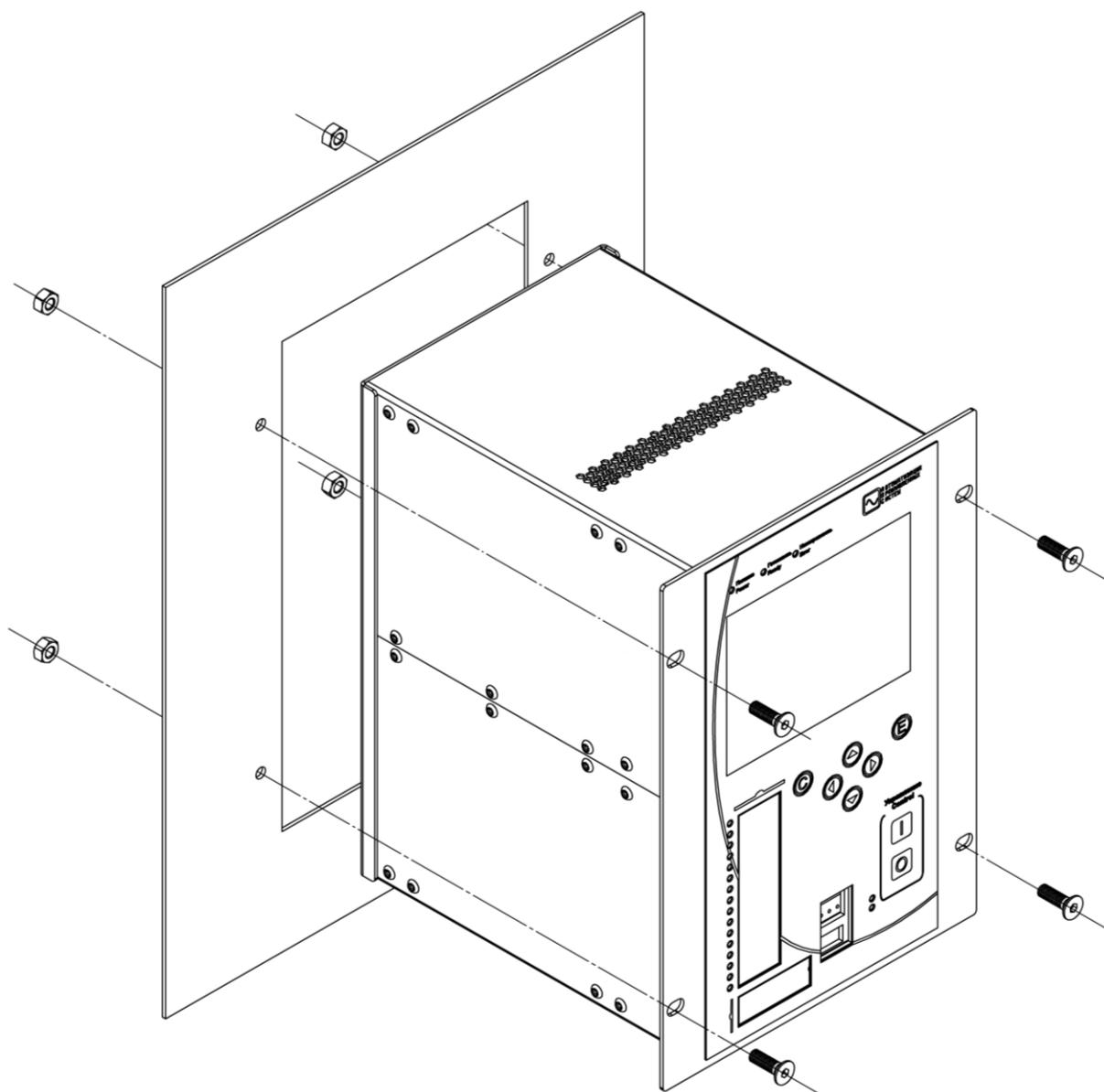
**Рис. П2.9.** CutOut крепления терминала «МИР 100» с внешней стороны шкафа
