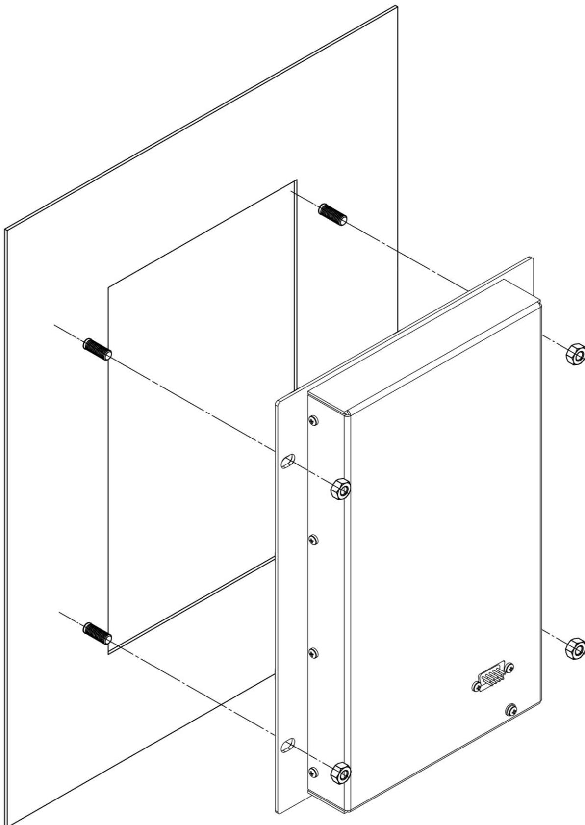
Рис. П2.11. CutOut крепления выносного дисплея с внутренней стороны шкафа
