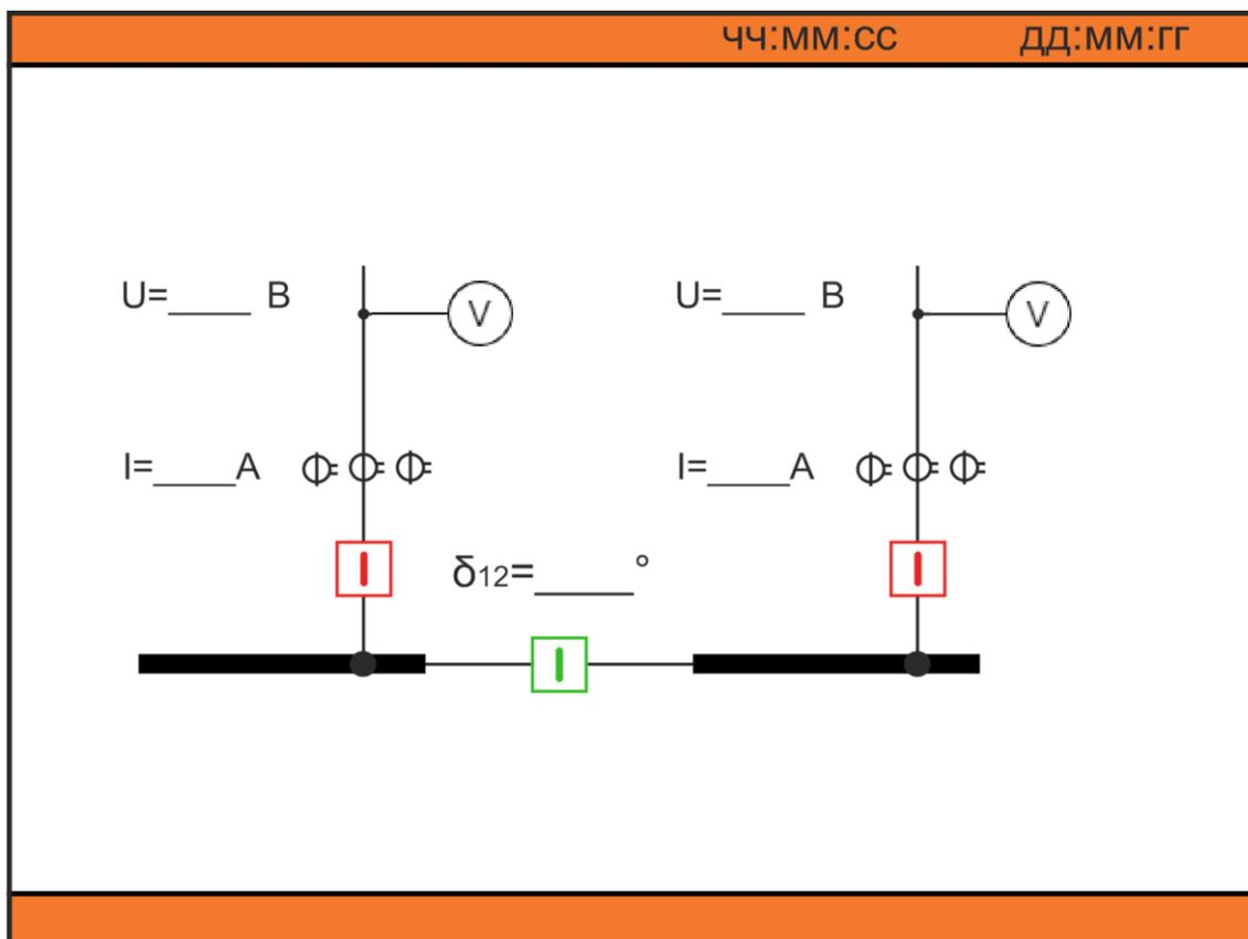
Рис.2.4.1. Мнемосхема терминала АВР
