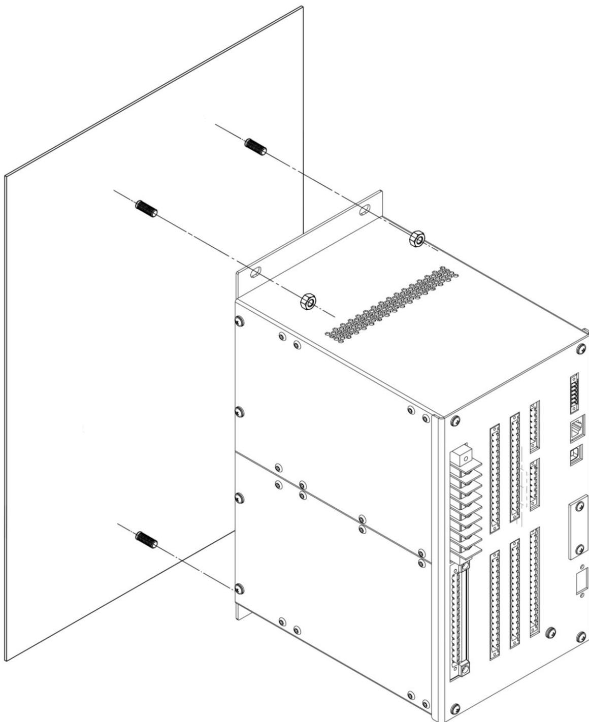
**Рис. П2.15.** CutOut крепления основной части терминала «МИР 100» с выносным дисплеем
