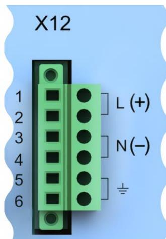
Рис. 1.4.1. Контакты разъема X12 для подключения цепей питания
