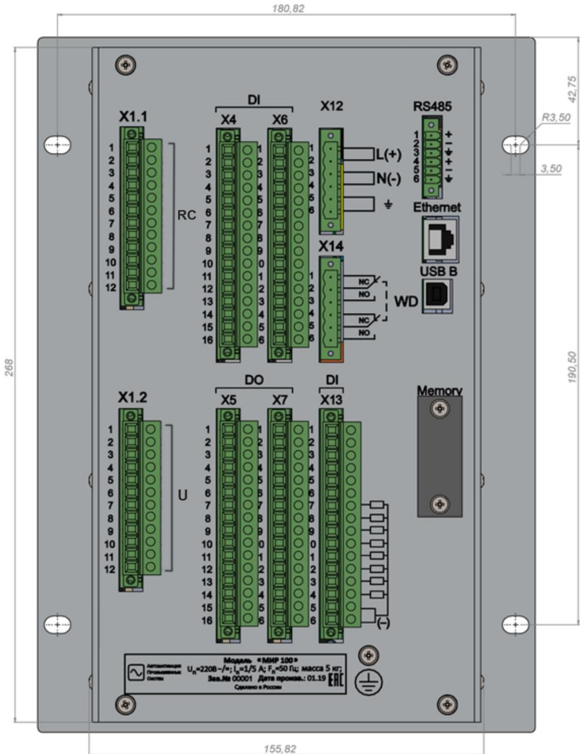
Рис. П2.4. Чертеж задней части терминала «МИР 100»
