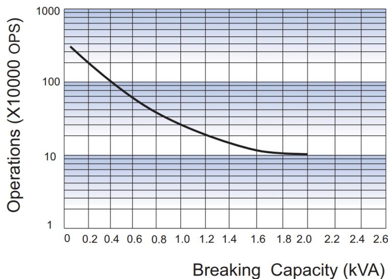
Коммутационную способность в цепях постоянного тока напряжением 220 В на размыкание резистивной нагрузки 0,15 А до 300 000 раз и 0,3 А до 200 000 раз.
