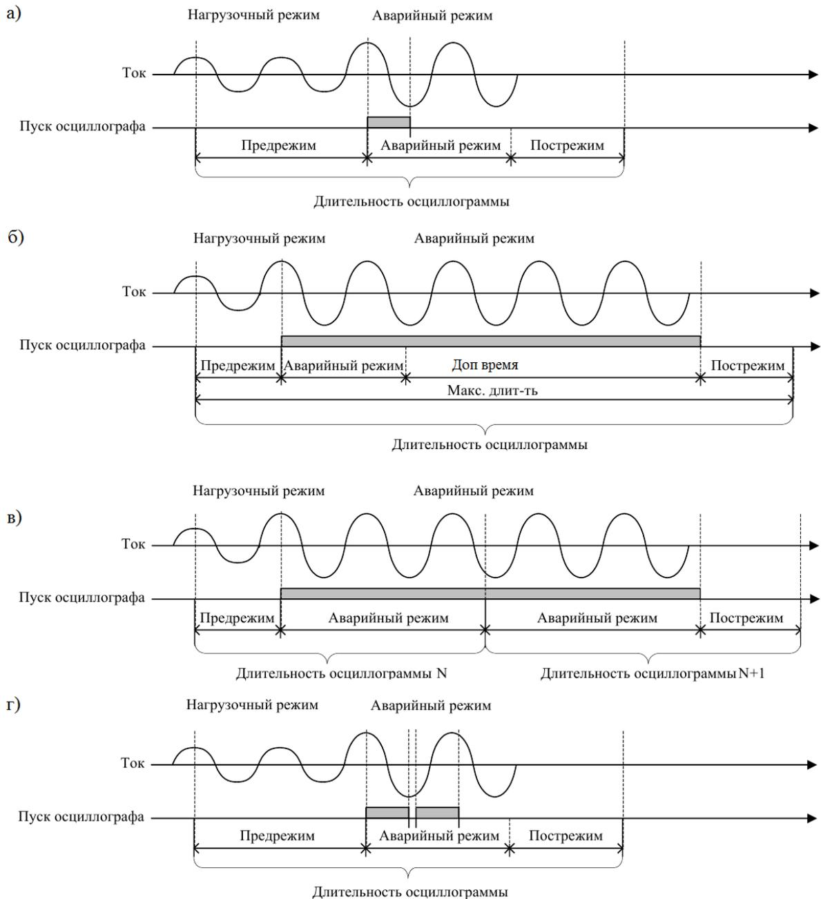
**Рисунок 1.4.5.** Алгоритм работы осциллографа:
