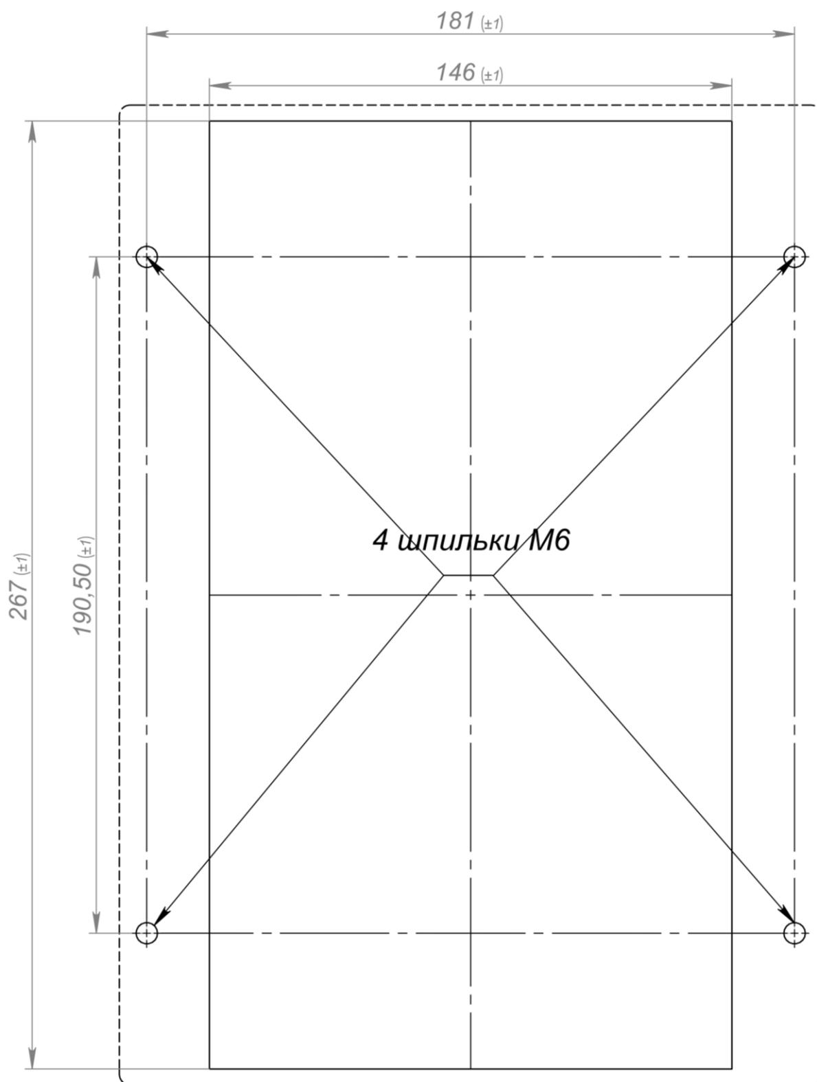
**Рис. П2.12.** Монтажные отверстия для установки выносного дисплея с внутренней стороны шкафа
