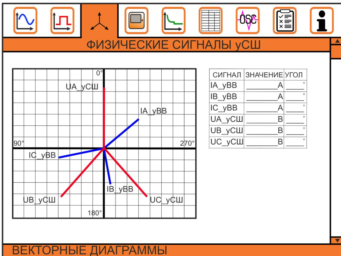
Рис. 2.4.10. Окно вкладки «Векторные диаграммы: физические сигналы»
