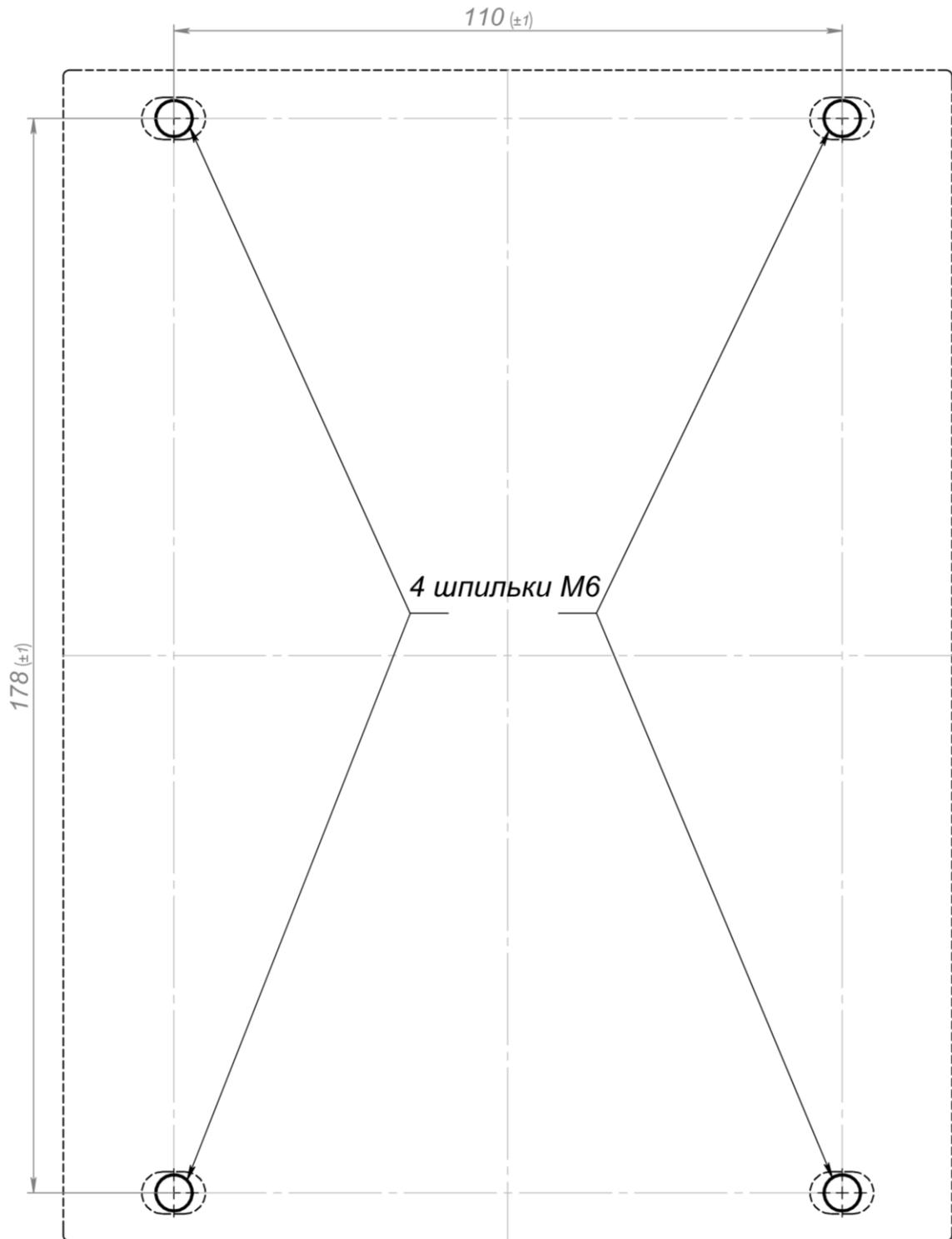
**Рис. П2.16.** Монтажные отверстия для установки основной части терминала «МИР 100»
