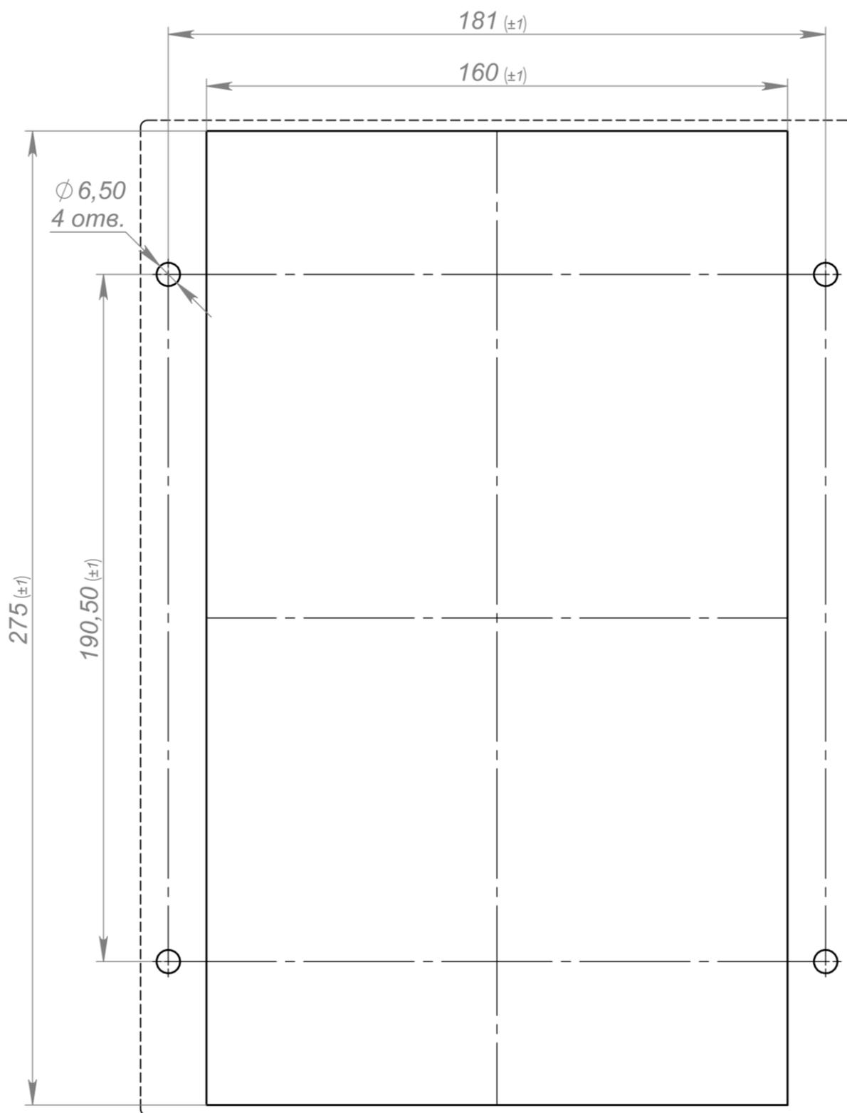
**Рис. П2.10.** Монтажные отверстия для установки терминала «МИР 100» с внешней стороны шкафа
