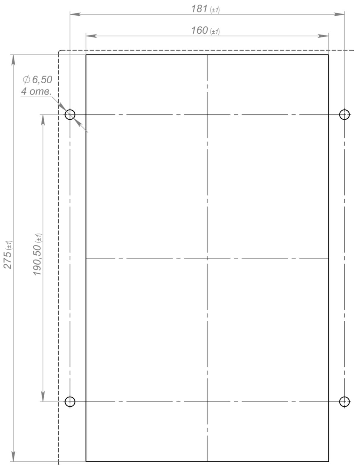
**Рис. П2.14.** Монтажные отверстия для установки выносного дисплея с внешней стороны шкафа
