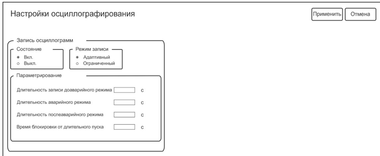
Рис. 1.4.4. Окно вкладки «Настройки осциллографирования» в ПО MIRAPS
