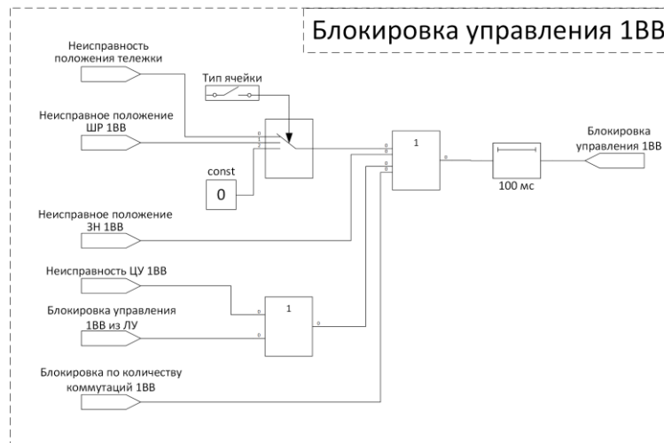
Рис. ЦУ. 5. Схема работы «Блокировка управления 1ВВ» (Аналогично осуществляется работа 2ВВ)
