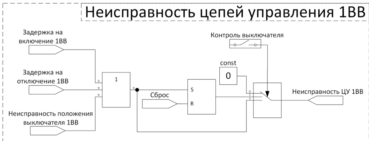
Рис. ЦУ. 4. Схема работы блока «Неисправность ЦУ 1ВВ».
