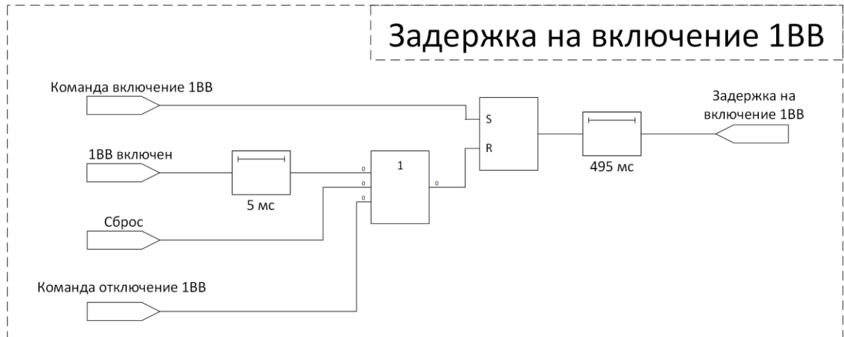
Рис. ЦУ. 3. Схема работы блока «Задержка на включение 1ВВ».
