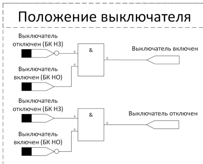
Рис. ЦУ. 1 Схема работы блока «Положение выключателя»
