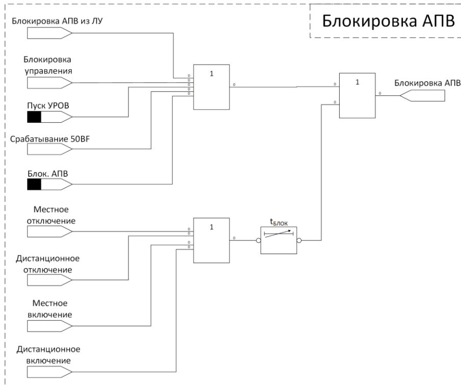
Рис. 79. 1. Схема работы блокировки АПВ
