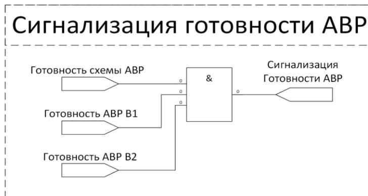
**Рис. АВР. 6.** Схема работы блока «Сигнализация готовности АВР»
