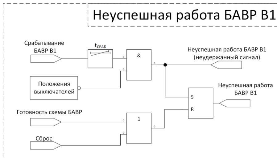
Рис. БАВР. 9. Схема работы блока «Неуспешная работа БАВР В1».
