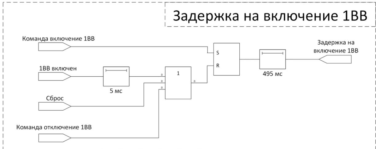
**Рис. ЦУ. 3.** Схема работы блока «Задержка на включение 1ВВ».
