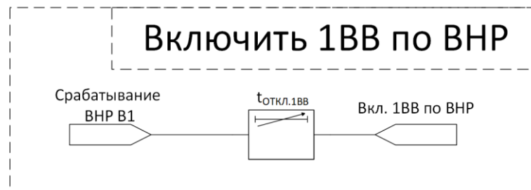
Рис. ВНР. 9. Схема работы блока «Включить 1ВВ по ВНР». (Аналогично осуществляется работа для 2ВВ)
