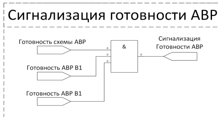
Рис. АВР. 6. Схема работы блока «Сигнализация готовности АВР»
